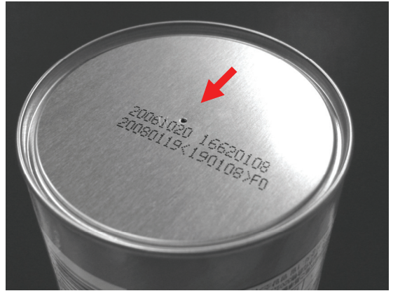
圖一、於洋芋片罐底端鑽一小孔
